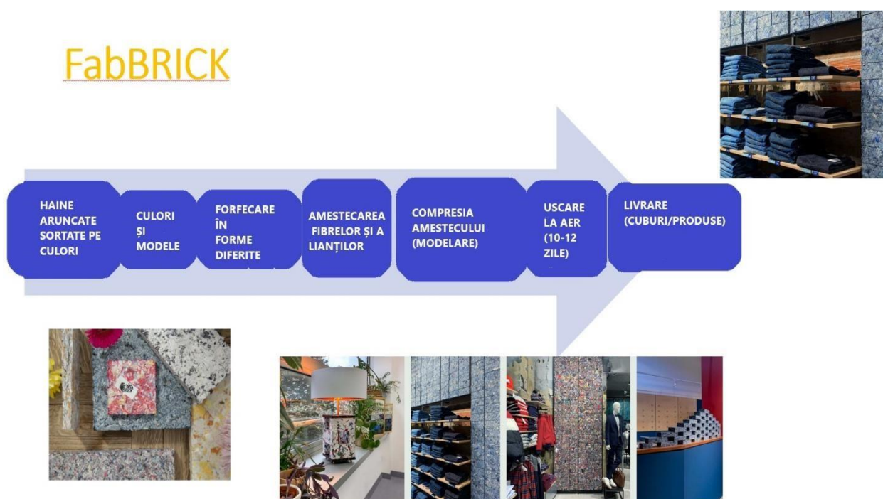
Fig. nr. 27 reciclarea mecanică FabBRICK 79
