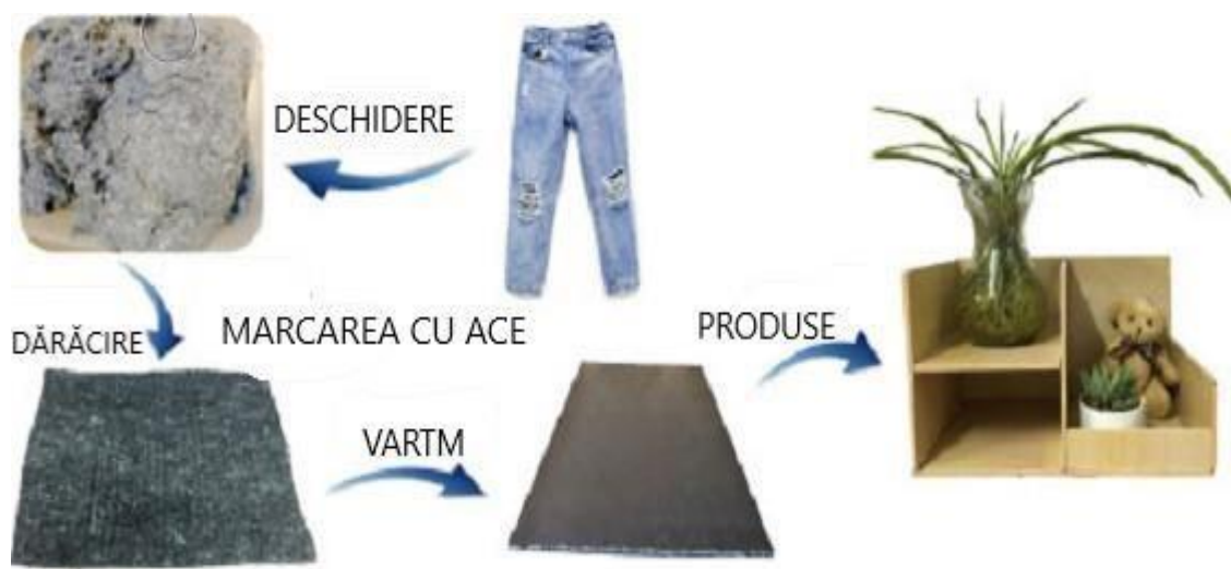
Fig. nr. 26 Tehnologia reciclării VARTM 78
