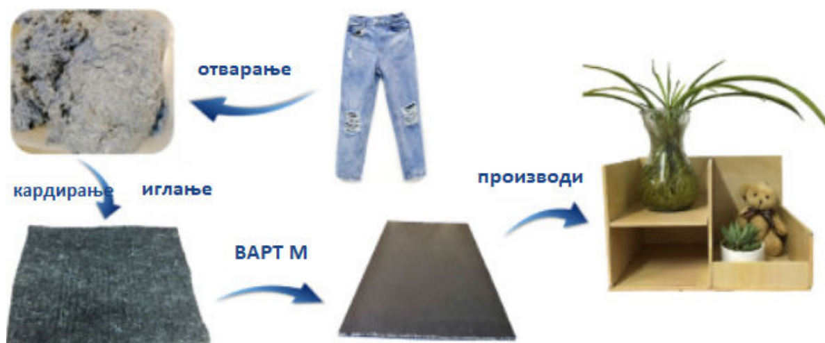
Слика бр. 26 VARTM технологија рециклирања 2
