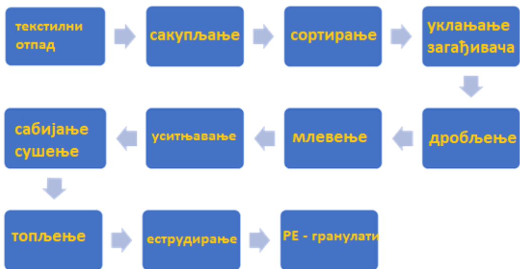
Слика бр. 28 Кораци термичке рециклаже Улазни материјали погодни за термичку рециклажу наведени су на слици 29.
