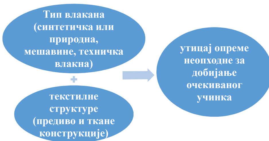
Слика бр. 25 Фактори утицаја на продукте механичке рециклаже
