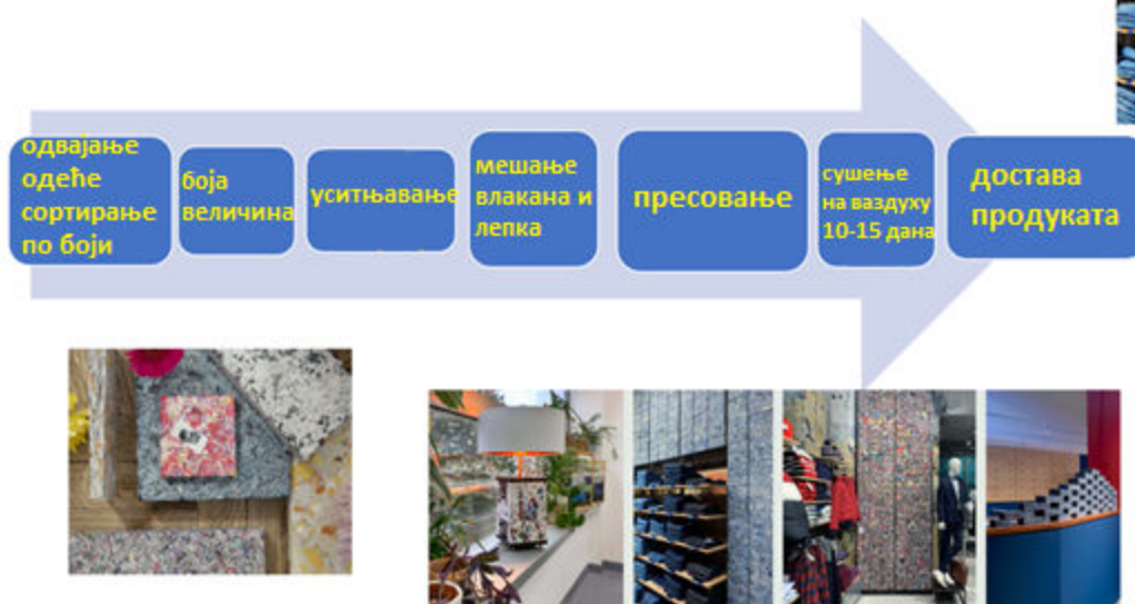
Слика бр. 27 Механичка рециклажа компаније FabBRICK
