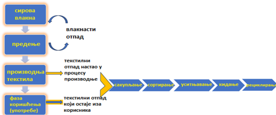
Слика бр. 22 Општа шема механичке рециклаже
