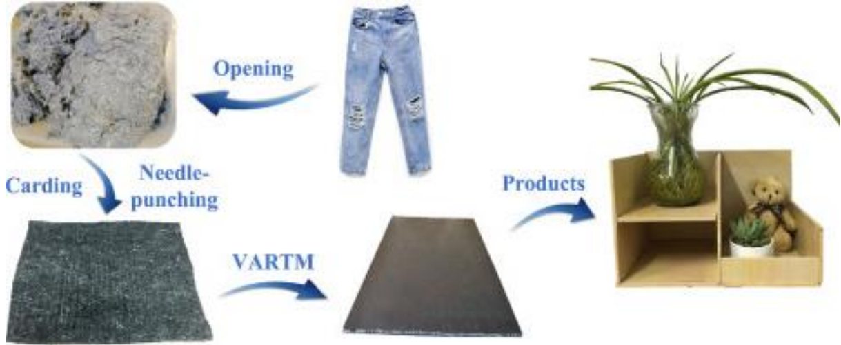
Şekil no. 26 VARTM geri dönüşüm teknolojisi 79
